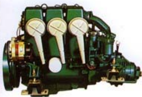
Inombordsmotorn är en Volvo Penta diesel på 36 hästkrafter försedd med dubbla batterier. Toppfarten är ca 8,5 knop, rekommenderad marschfart ca 7 knop. Motorrummet är lätt åtkomligt från både salong och sittbrunn.
